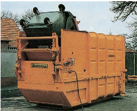
Bild 5: Müllpressbehälter mit angebauter kraftbetriebener Hub- und Kippvorrichtung. Anordnung des Steuerschalters unmittelbar neben dem Schwenkbereich, so dass die Bedienungsperson eine gute Übersicht über den Wirkbereich auch bei eingehängtem Sammelbehälter besitzt.
